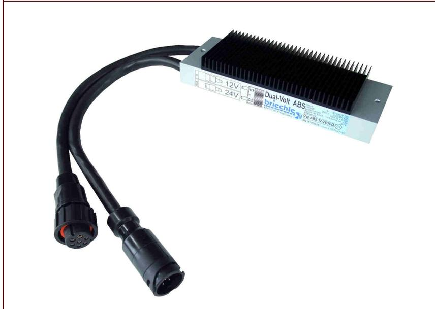
Spezialwandler zur Versorgung eines 24V ABS/EBS-Systems aus 12V oder 24V. Der Wandler ist mit ABS/EBS Bajonettsteckverbindungen ausgestattet. Für die Montage in der Anhängerleitung. Die Pins 6 und 7 ("CAN-Bus") sind durchverbunden. Achtung! Canbus-Leitungen erfordern noch einen separaten Pegelconverter. Ohne Pegelconverter entfällt die EBS-Funktionalität, die Bremse läuft dann korrekt auf ABS-Standard.
