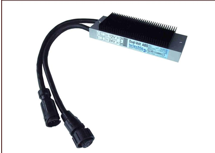
Spezialwandler zur Versorgung eines 24V ABS/EBS-Systems aus 12V oder 24V. Konfiguration: Eingang ABS/EBS Bajonettstecker, Ausgang ABS/EBS Bajonettkupplung (Reverse-Konfiguration). Die Pins 6 und 7 ("CAN-Bus") sind durchverbunden. Achtung! Canbus-Leitungen erfordern einen separaten Pegelconverter. Ohne Pegelconverter entfällt die EBS-Funktionalität, die Bremse läuft dann auf ABS-Standard.
