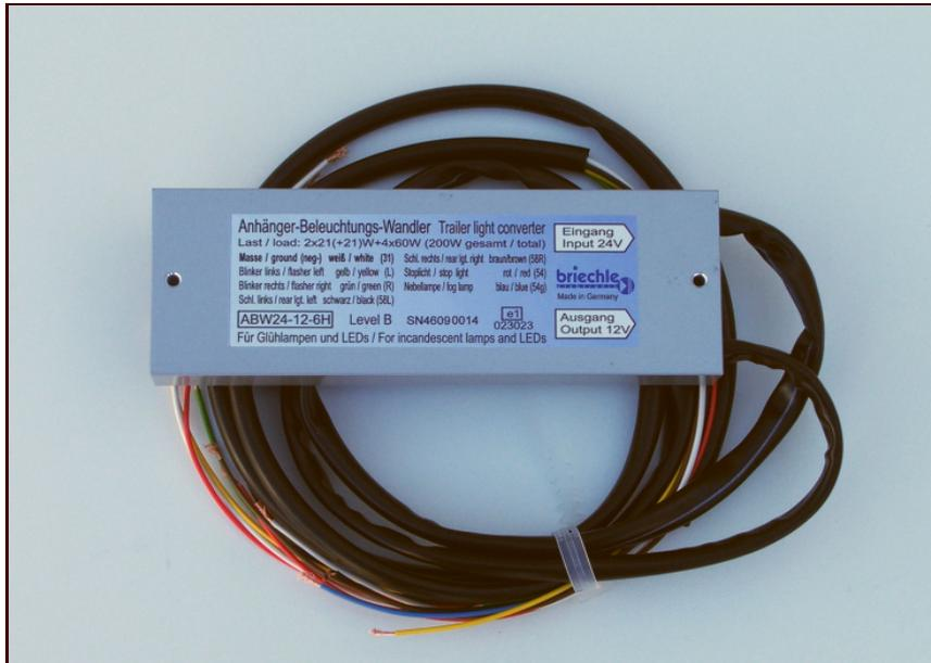
Wandler zur Versorgung der Beleuchtung von 12V-Anhängern aus einem 24V-Bordnetz. Es können Glühlampen und geeignete RMS-fähige-Leuchtdioden versorgt werden. Über die RMS-Eignung gibt der Hersteller der LED-Leuchte Auskunft. Weitere Details in unserem Merkblatt "LED-Leuchten im RMS-Betrieb".
