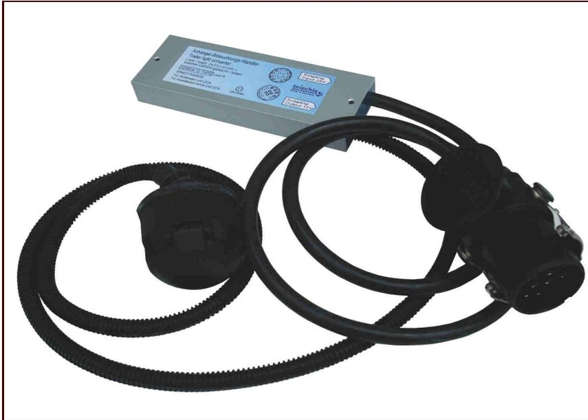
Wandler zur Versorgung von 12V-Anhängern aus einem 24V-Bordnetz, mit Rückfahrleuchte. Es können Glühlampen und geeignete RMS-fähige-Leuchtdioden versorgt werden. Über die RMS-Eignung gibt der Hersteller der LED-Leuchte Auskunft. Weitere Details in unserem Merkblatt "LED-Leuchten im RMS-Betrieb". Eingang 15-poliger Stecker, Ausgang 13-polige Dose.
