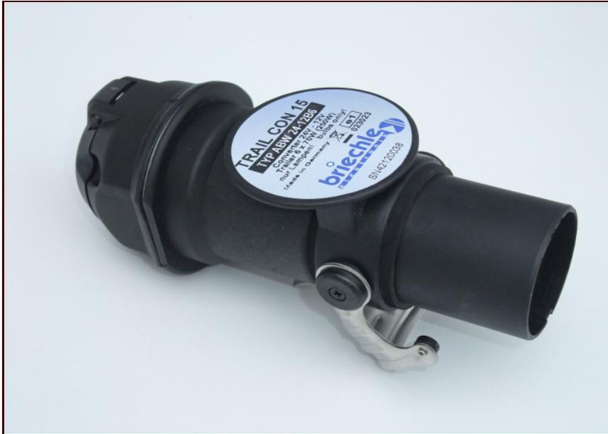
Wandler zur Versorgung der Beleuchtung von 12V-Anhängern aus einem 24V-Bordnetz als Kurzadapter von 15-polig auf 7-polig. Die Rückfahrleuchte ist nicht beschaltet. Es können Glühlampen und geeignete RMS-fähige-Leuchtdioden versorgt werden. Über die RMS-Eignung gibt der Hersteller der LED-Leuchte Auskunft. Weitere Details in unserem Merkblatt "LED-Leuchten im RMS-Betrieb".
