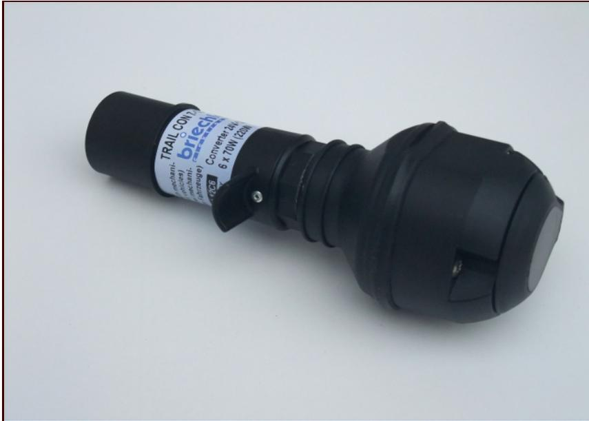
Wandler zur Versorgung der Beleuchtung von 12V-Anhängern aus einem 24V-Bordnetz als Kurzadapter von 7-polig auf 13-polig. Die Rückfahrleuchte ist nicht beschaltet. Es können Glühlampen und geeignete RMS-fähige-Leuchtdioden versorgt werden. Über die RMS-Eignung gibt der Hersteller der LED-Leuchte Auskunft. Weitere Details in unserem Merkblatt "LED-Leuchten im RMS-Betrieb".
