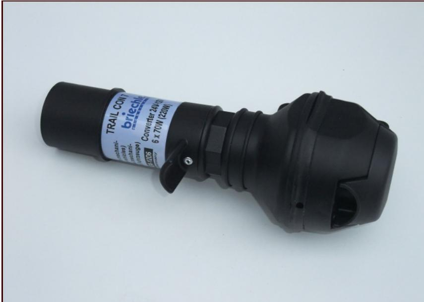
Wandler zur Versorgung der Beleuchtung von 12V-Anhängern aus einem 24V-Bordnetz als Kurzadapter von 7-polig auf 7-polig. Es können Glühlampen und geeignete RMS-fähige-Leuchtdioden versorgt werden. Über die RMS-Eignung gibt der Hersteller der LED-Leuchte Auskunft. Weitere Details in unserem Merkblatt "LED-Leuchten im RMS-Betrieb".
