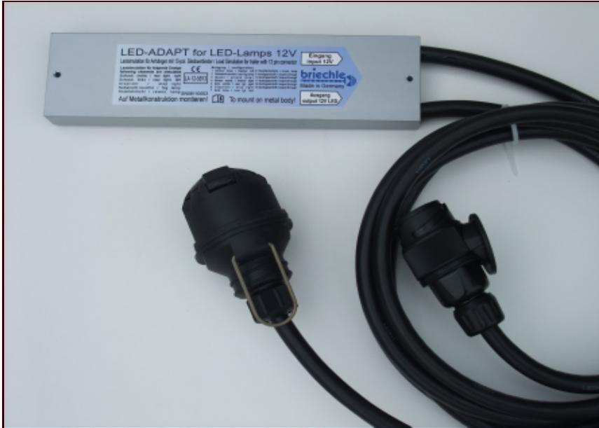
12 Volt Widerstands - Ersatzlast zur Anpassung von Leuchtdioden-Anhängerlampen an Fahrzeuge mit Glühlampenüberwachung. Die Blinklampen und die Kontakte 9 bis 13 sind durchgeschleift. LED-ADAPT muss auf eine Metallfläche montiert werden. Wichtig: Die Blinklampen müssen Glühlampen sein oder LEDs mit eigener Überwachung. Andere Zweige dürfen maximal 10W Zusatzlast zur LED haben, Überwachung ist dann inaktiv.
