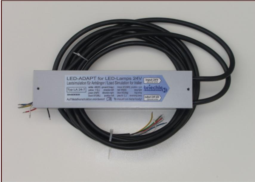
24 Volt Widerstands - Ersatzlast zur Anpassung von Leuchtdioden-Anhängerlampen an Fahrzeuge mit Glühlampenüberwachung. Der Ausfall einer LED-Einheit wird erkannt und die Ersatzlast abgeschaltet. LED-ADAPT muss auf eine Metallfläche montiert werden. **\*\*\*ACHTUNG\*\*\*** Der Anschluss von Glühlampen am Ausgang ist unzulässig. Der Kurzschlusschutz schaltet unter Umständen erst nach mehreren Minuten ab!
