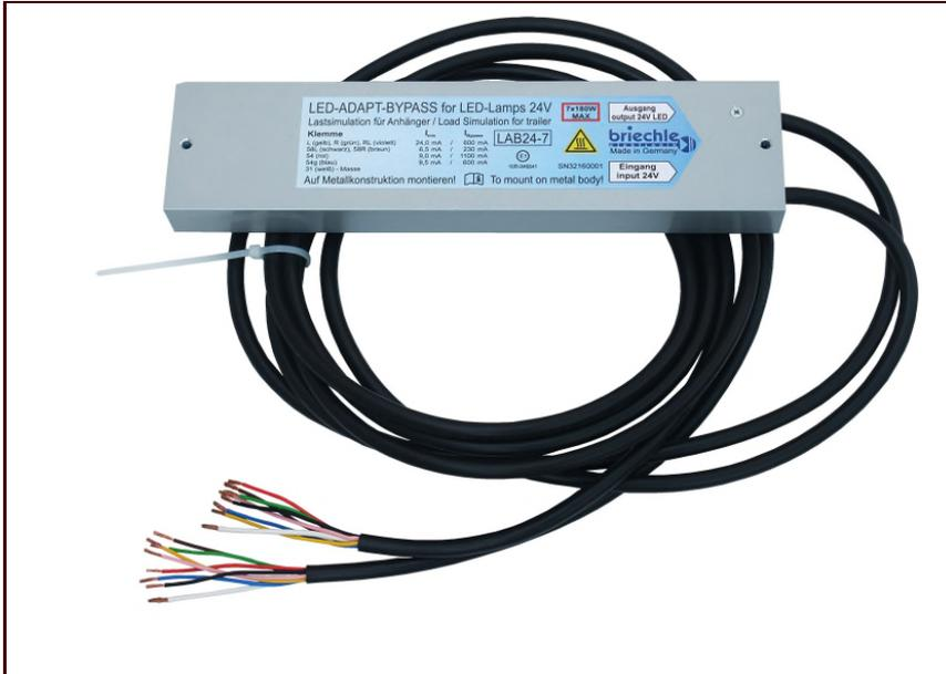
24 Volt Widerstands-Ersatzlast zur Anpassung von Leuchtdioden-Anhängerlampen an Fahrzeugen mit Glühlampenüberwachung. Der LED-Ausfall wird erkannt und die Ersatzlast abgeschaltet. Zur Kühlung ist eine Metallfläche nötig. Die Bypass-Funktion ermöglicht den nachträglichen Anschluss von Glühlampen bis zu 180W.
