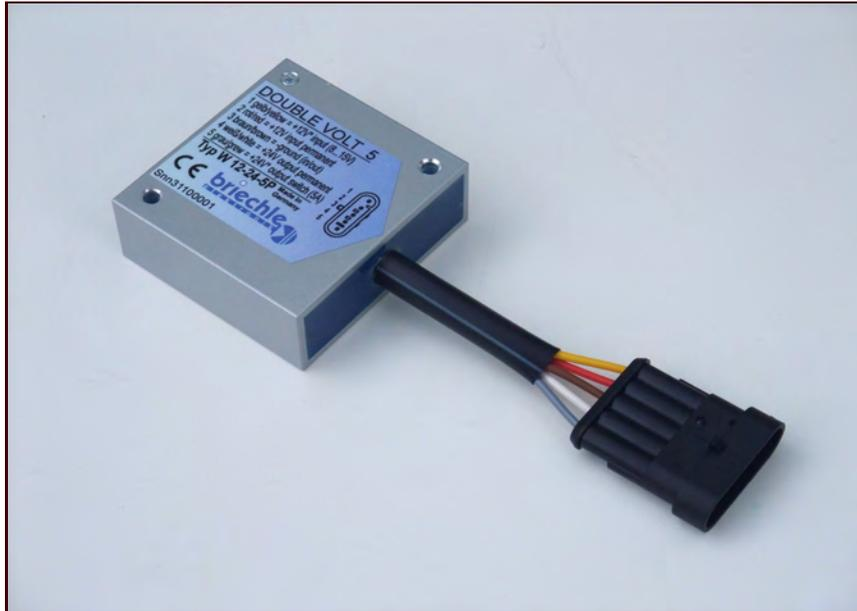
Aufwärtswandler mittlerer Leistung von 12V bis 24V (Weitbereich) auf 24V. Zur gleichzeitigen Versorgung von Dauerplus und Zündungsplus. Der Gesamtstrom kann beliebig auf beide Ausgänge aufgeteilt werden.
