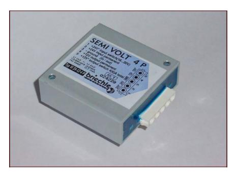
High-End Spannungswandler kleiner Leistung für 12V-Verbraucher am 24V-Bordnetz. Gleichzeitige Versorgung von Dauerplus und Zündungsplus Ideal für die dezentrale Versorgung von Navigations- und Ortungssystemen.
